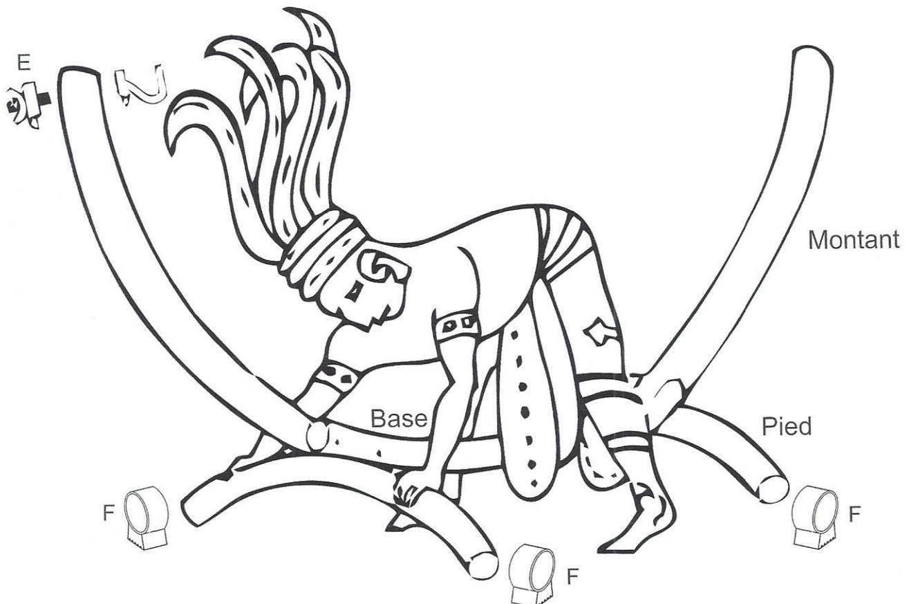
L'astuce : ne serrez pas les boulons, laissez-les très lâches. Cela vous permettra de faire pivoter les pieds pour réussir à placer tous les trous face à face. Une fois toutes les pièces assemblées, placez les deux pieds bien à plat sur le sol pour stabiliser le support et serrez définitivement tous les boulons. Pour les conseils d'entretien, reportez-vous à la double page jointe à cet envoi. Bonne installation et bonnes siestes !
